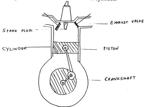
INTAKE POSITION. INTERNAL COMBUSTION ENGINE
