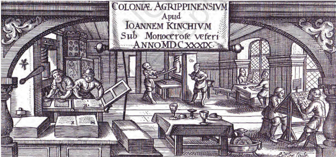
चित्र 8 - एक मुद्रक की वर्कशॉप, सोलहवीं सदी। इस तसवीर से पता चलता है कि सोलहवीं सदी में मुद्रक का कार्यस्थल कैसा दिखायी देता था। सारे काम एक ही छत के नीचे चल रहे हैं। दाएँ छोर पर अगले हिस्से में कम्पोज़ीटर काम कर रहे हैं। बाएँ सिरे पर गैलीज़ तैयार किए जा रहे हैं और धातुई अक्षरों पर स्याही लगाई जा रही है। पृष्ठभूमि में प्रिंटरस प्रेस के पंच कस रहे हैं और उन्हीं के पास पूफ़रीडर काम में जुटे हैं। बिलकुल अगले भाग में तैयार माल पड़ा है। ये दो-दो पृष्ठ वाले छपे हुए पन्ने हैं जिनकी बाईंडिंग होनी है।
